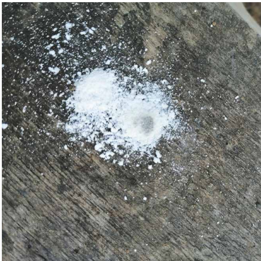
Рис. 3. Выпадение кристаллов оксида натрия Na_2O в газовом расходомере на скважине А-20. Оксид натрия — бинарное неорганическое бесцветное вещество, имеющее химическую формулу Na_2O . Типичный представитель основных оксидов. бурно реагирует с водой. В природе в таком виде не существует. Для его образования нужна высокая температура и давление
